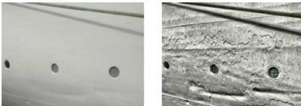
(c) 船舶の外壁塗装剥がれと船体凹み
